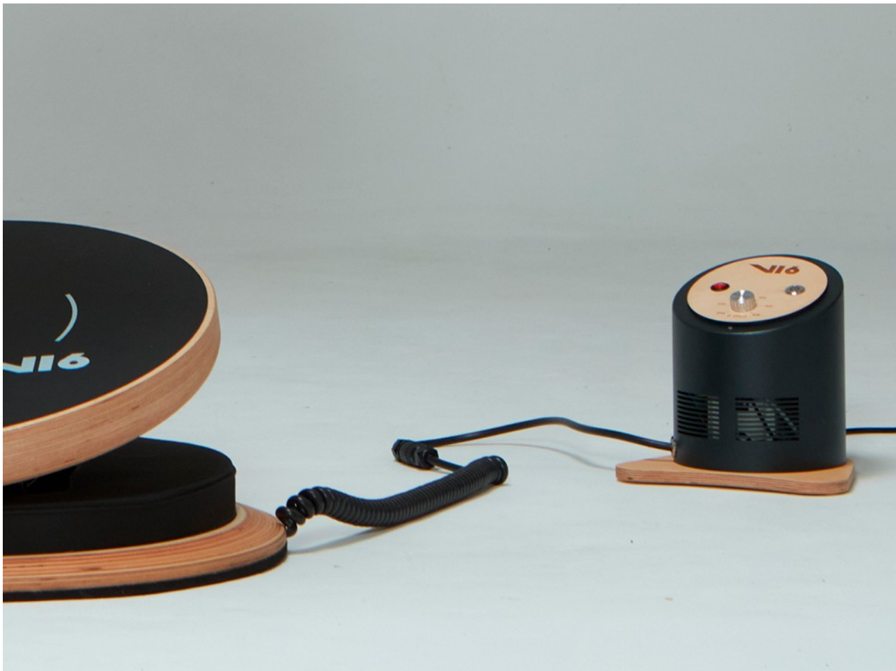
Figura 4. Conexión de la plataforma vibratoria a la torre de control
